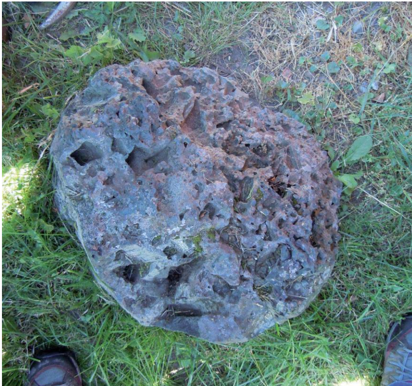
Figur 2. Bottenslagg som är utställd vid Hällestads hembygdsgård. Slaggens diameter är ca 0,40 my. Foto ovanifrån, Erika Räf.
