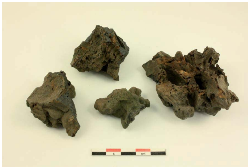
Figur 3. Provtagna slaggbitar från den stora bottenlaggen från Hällestad, Östergötland. Slaggen är uppbyggd av flera pålagrade, tunna slaggflöden. Foto Lena Grandin.
