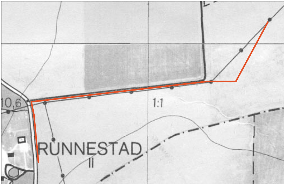
Figur 3. Utdrag ur Ekonomiska kartans blad 084 28 (8E 2i Valla) med kabelsträckningen markerad. Skala 1:5 000.
