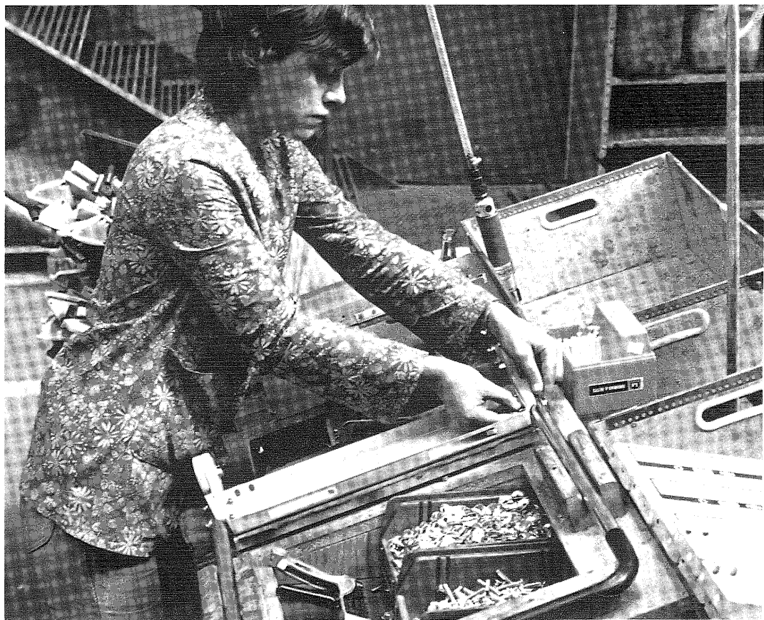
Delarna till ett styre monteras samman. Detta är den nya, förzinkade modellen.
